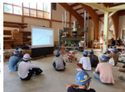
実大強度試験機での曲げ試験の様子
